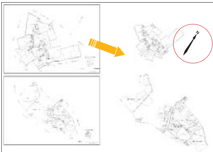
Orientation automatique des sections cadastrales effectuée par le logiciel, mise à l'échelle, détourage et nettoyage de l'image.
